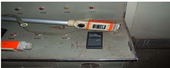
图 3 监测及防护仪器情况(辐照室门口无检验源,FD-71 便携式辐射检测仪不能正常工作,人员未配带个人剂量报警仪)
