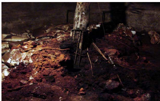
图 4 被辣椒粉压倒的护源罩，以及周围燃烧后的辣椒粉
